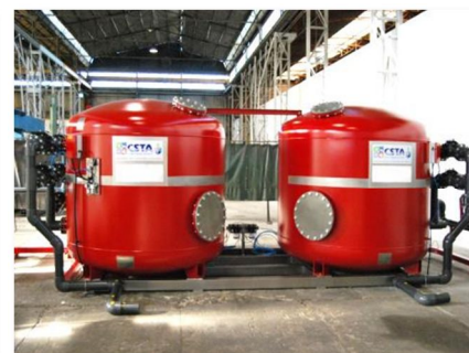
Impianto di filtrazione dell'acqua grezza
