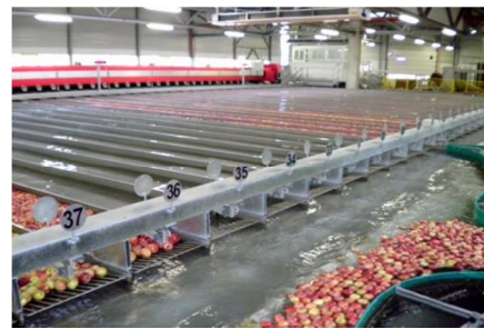
Linee di lavorazione con acqua osmotizzata, filtrata e debatterizzata con ricircolo in continuo
