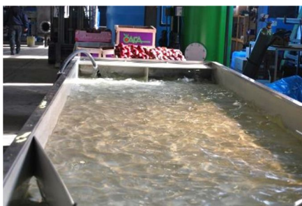
Linee di lavorazione con acqua osmotizzata, filtrata e debatterizzata con ricircolo in continuo
