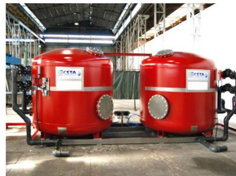
Impianto di pre-trattamento per la filtrazione dell'acqua grezza
