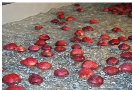
Linee di lavorazione con acqua osmotizzata, filtrata e debatterizzata con ricircolo in continuo
