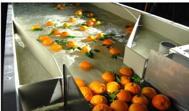
Linea di lavorazione con acqua pre-refrigerata e trattata
