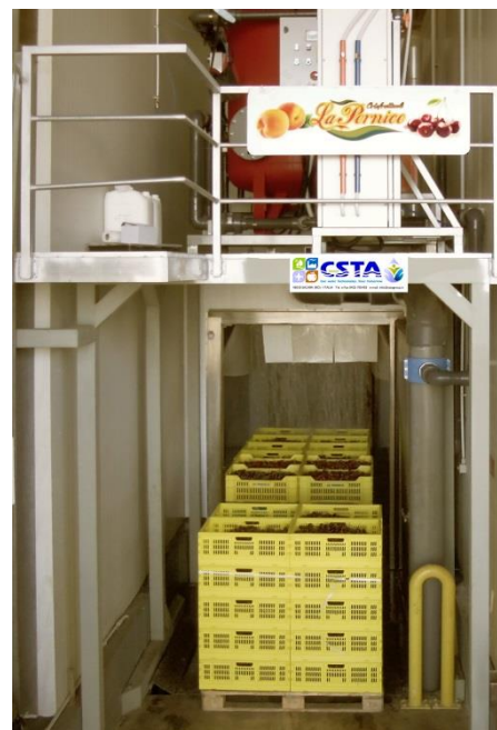
FOTO 23 – Linea per il lavaggio a doccia PHOTO 23 – Shower cleaning line
