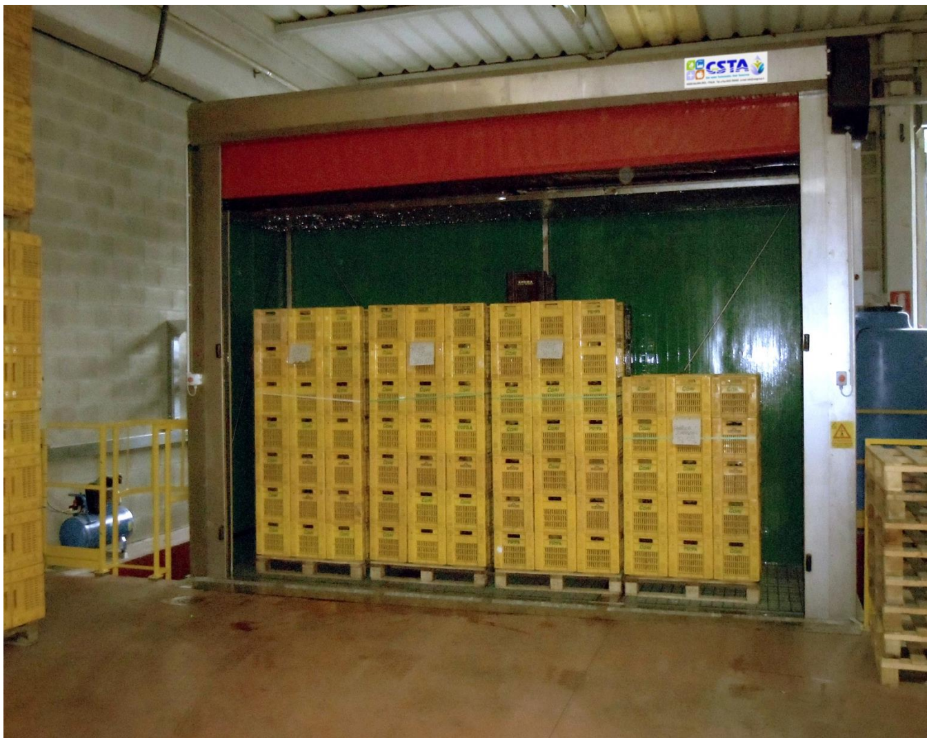
FOTO 21 – Cella per il lavaggio a doccia PHOTO 21 – Shower cleaning cellar
