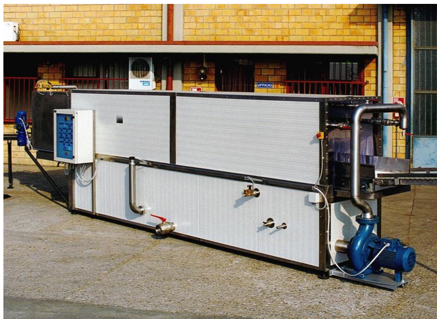
FOTO 22 – Cella per il lavaggio a doccia PHOTO 22 – Shower cleaning cellar
