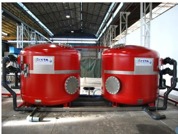
FOTO 17 - Impianto di pre-trattamento per la filtrazione e la rimozione di Ferro e Manganese dall'acqua grezza PHOTO 17 - The machinery used to pre filter crude water, in order to remove Iron and Manganese
